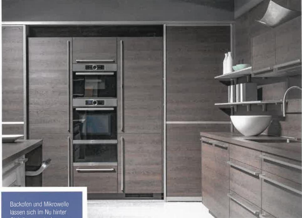
Backofen und Mikrowelle lassen sich im Nu hinter Gleittüren verstecken. Diese aus dem Nobilia-Portfolio sind boden- und deckengeführt. Sie haben einen Rahmen in Silber eloxiert und eine holzartige Dekorfüllung.
