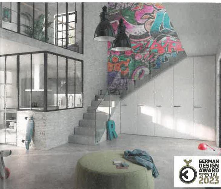
Das prämierte **Raumgliederungssystem** „Verrière“ ist für den individuellen, designorientierten Innenausbau konzipiert. Es besteht aus variabel einsetzbaren Trennelementen. Basis: filigrane Aluminiumprofile und Glasfüllung. Raumplus
